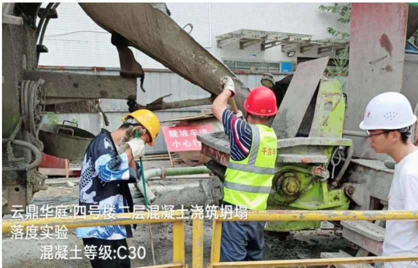
图 3- 10 企业师傅指导学生进行施工现场混凝土塌落度实验
